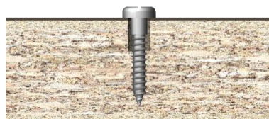
Figura 9: îmbinare cu șuruburi cu găurire prealabilă
