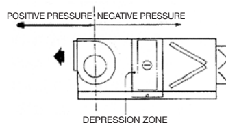
AHU WITH INLET FAN
