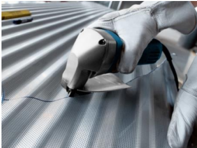
a. Foarfeca electrica pentru taiere tabla profilata
