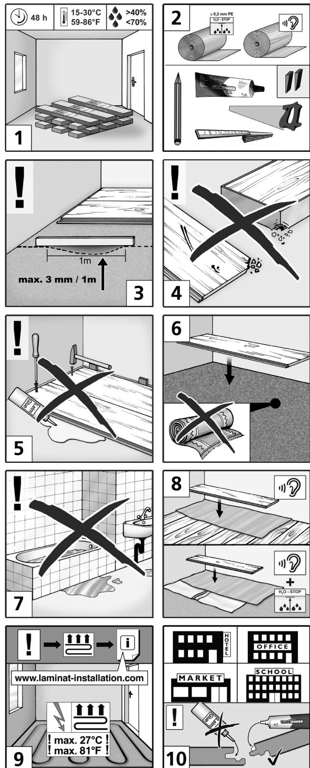
**Pregătirea:** Cu 48 de ore înainte de montare, vă rugăm să depozitați parchetul în aceleași condiții ambiante ca la montare [1]. O condiție importantă pentru montarea și păstrarea calităților parchetului laminat este un mediu ambiant cu o temperatură de cca. 20°C și o umiditate relativă a aerului de 50 – 70%.
