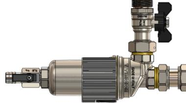
L'impianto deve essere progettato e realizzato in modo tale da evitare sollecitazioni tali da danneggiare la valvola ed impedirne la corretta tenuta ed il buon funzionamento. Per facilitare le operazioni di pulizia e manutenzione è suggerito installare delle valvole di intercettazione a monte ed a valle del filtro magnetico.
