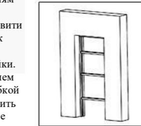
**6.РУС** – Перед заполнением пеной отверстий между коробкой и стеной необходимо установить планки распорные. Расстояние между боковыми стоечными должны быть одинаковыми по всей высоте стоек.
