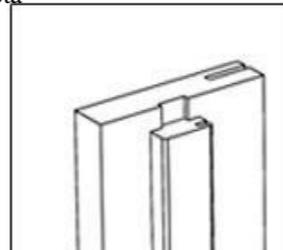
**3.РУС** – В стоечных, по центру паза под установку притворной планки, сделать отверстия для крепления коробки шурупами в дверном проеме.
