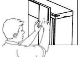
**11.РУС** – При克莱йте комплект наличника к торцам коробки kleem „жидкие гвозди“. Наличник должен плотно прилегать к поверхности стены и коробки.
