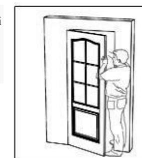
**12.РУС** – Навесить дверное полотно на петли. Зазор между полотном и коробкой должен быть 3-4мм. Установить дверные ручки.
