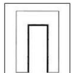
полотна, толщину коробки и в случае необходимости подобрать доборные планки. Рекомендуемый зазор между стеной и дверной коробкой 15 мм.
