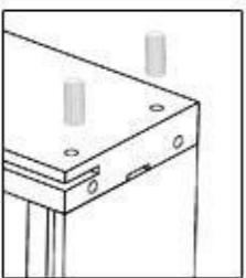
**4.РУС** – Просверлить отверстия в местах соединения поперечин и стоек. Скрепить между собой поперечину и стойки с помощью шкантов на клею ПВА.
