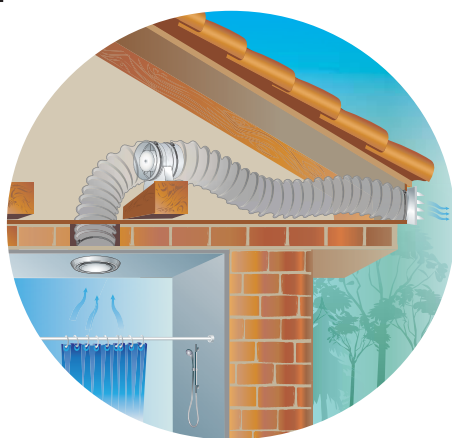
VKOk1 fan cottage ventilation example
