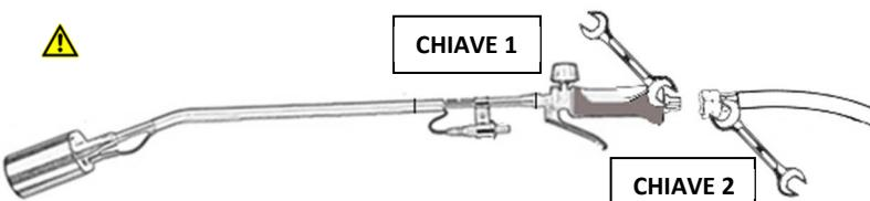
**Quando si utilizza il butano**, collegare il tubo alla valvola della bombola. ATTENZIONE: verificare la tenuta tra il raccordo del tubo e la valvola della bombola. La pressione non deve superare i 3 bar.
