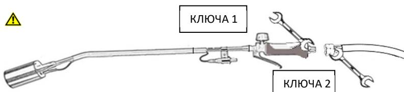
**При использовании бутана, соедините шланг с клапаном цилиндра.**
