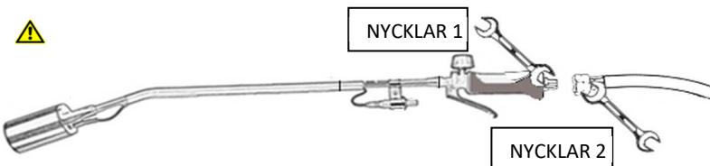
**Om butangas används**, anslut slangen till cylinderventilen. **VARNING:** kontrollera att anslutningen mellan slangen och cylinderventilen är åtdragen. Trycket får inte överstiga 3 bar.
