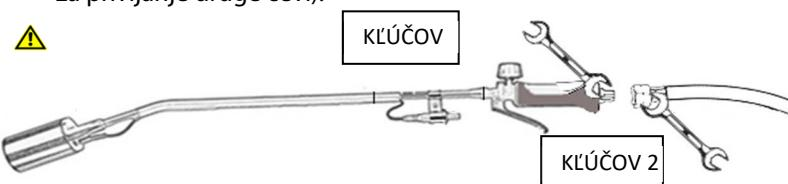
**Pri uporabi butana**, priključte cev na ventil jeklenke. OPOZORILO: preverite tesnosť med priključkom cevi in ventilom jeklenke. Tlak ne sme presegati 3barov
