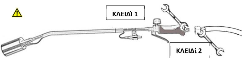
**Όταν χρησιμοποιείται βουτάνιο, συνδέστε το λάστιχο στη βαλβίδα του κυλίνδρου.**
