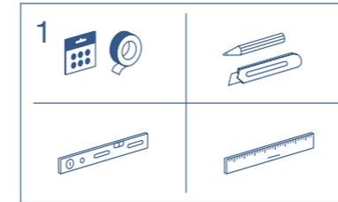
**1. Pregatiti: Velcro sau banda Velcro, creion, cutter, nivelă cu bula si riglă.**
