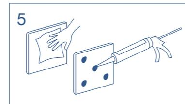
**5. Curățați partea din spate a panoului de praf cu o lavetă umedă. Apoi aplicați lipici în cinci puncte pe panou.**
