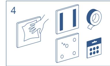
**4. Curățați partea din spate a panoului de praf cu o lavetă umedă. Apoi lipiți banda Velcro sau Velcro pe panoul de pe partea albă.**
