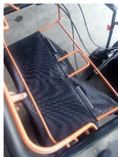
Figura 37- 3 Scoateți puntea de colectare
