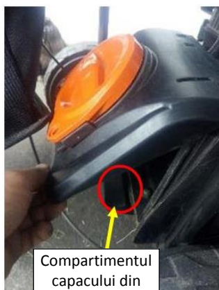
Figura 33-1 Închideți capacul din spate
