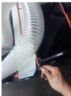
Figura 37 - 2 Scoateți placa de atașare de la sacul de colectare
