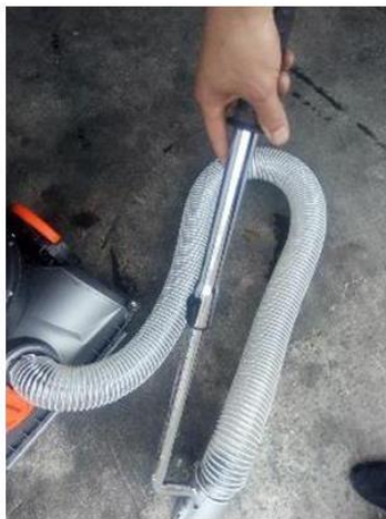
Figura 3-22 Reglați lungimea telescopică
