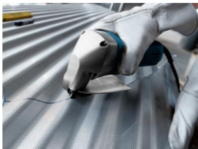
a. Foarfeca electrica pentru taiere tabla profilata
